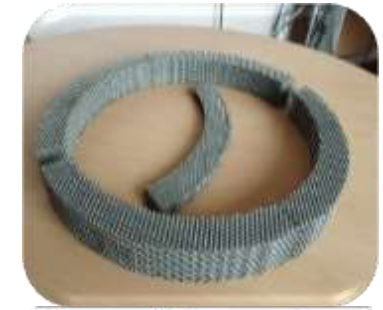
Mousse métallique amortissante d'un conteneur
